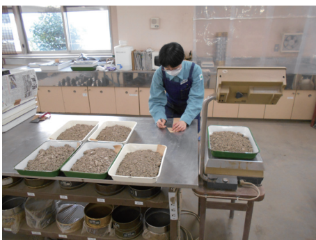
掘削土(乾燥)の計量
