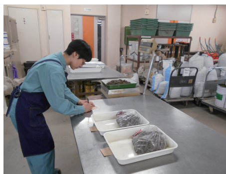
掘削土(湿潤)の計量
