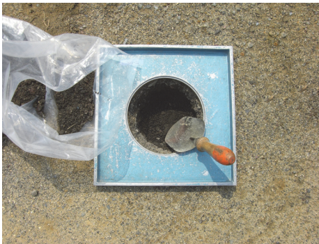
試験孔の掘削
